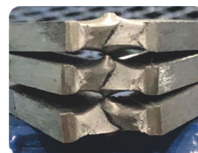
敬业440CL从左至右依次-20℃、-40℃冲击试样断口 From left to right: Impact fractures at -20℃ and -40℃ (Jingye 440CL)
